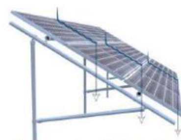
Un écoulement possible des eaux de pluies entre les modules
